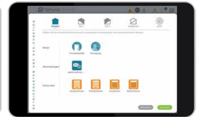
Erstellung der Sicherheitsmodi, Auswahl der aktiven Sensoren, der Benachrichtigungen sowie der Produkte, die in eine gewünschte Position fahren sollen.
