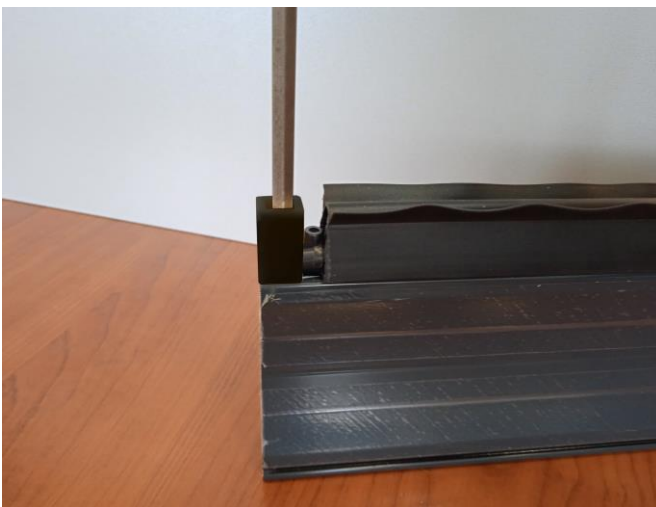
17. Przykręcamy bufora wkrętem stożkowym 4x22.
