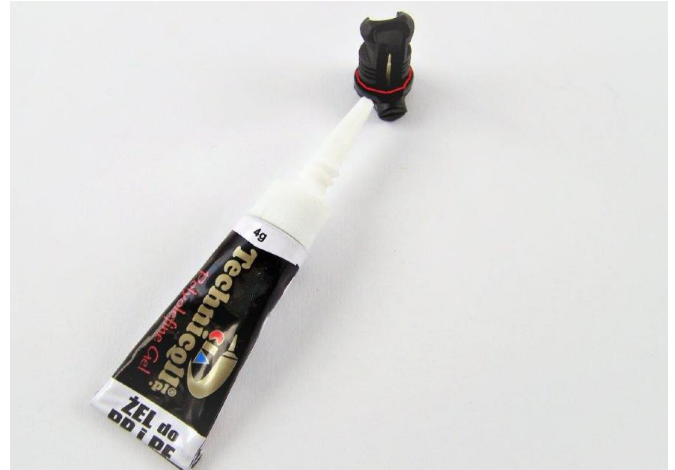
14. Odtłuszczamy listwę oraz wtyczkę z rezystorem. Następnie na wtyczkę nakładamy cienką warstwę żelu.
