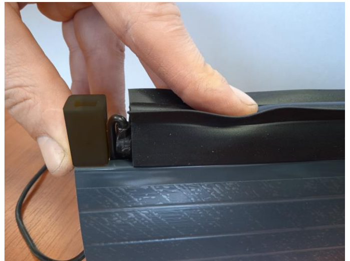
8. Dokładamy bufor tak aby był na równo z końcem listwy dolnej. ( do 2mm może bufor być wsunięty do środka listwy)
