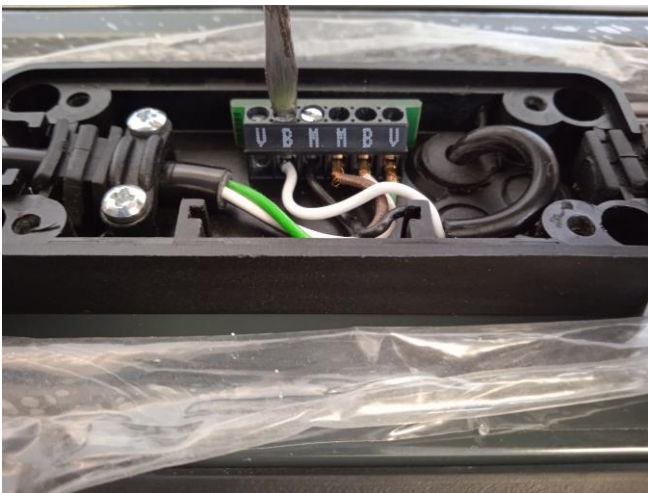
27. Podpinamy kable pod wolne wejścia w puszcze oznaczone symbolem „B,, i „M,,, (nie ma znaczenia który kolor pod które gniazdo)
