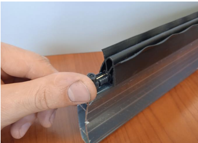
15. W wskazany sposób wsuwamy wtyczkę z rezystorem. Trzeba to zrobić szybko ze względu na szybko schnący klej.
