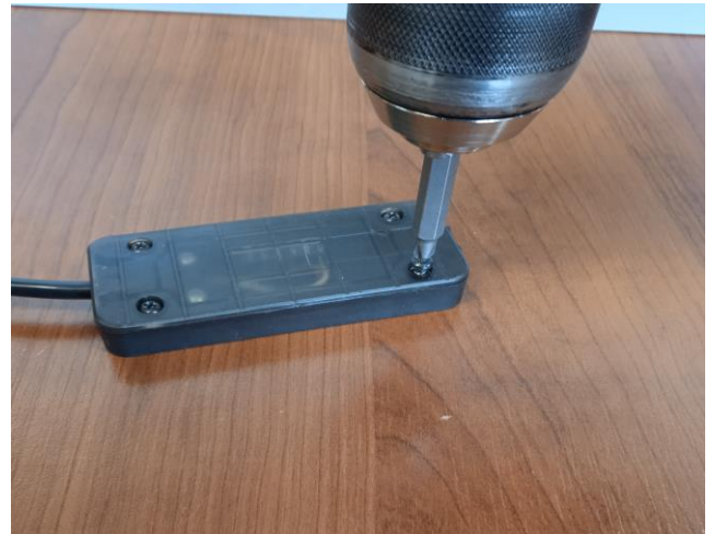
22. Otwieramy puszkę z kablem spiralnym odkręcając 4 śrubki.
