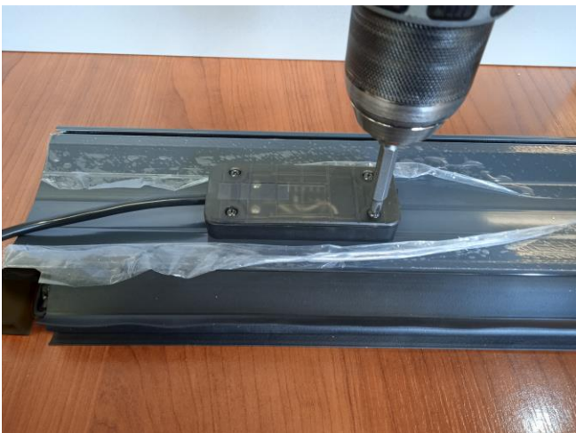
29. Zamykamy puszkę przykręcając ją 4 wkrętami.
