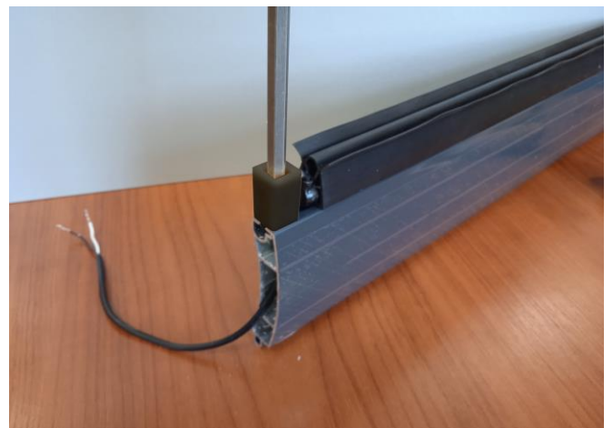
10. Przykręcamy bufor wkrętem stożkowym 4x22
