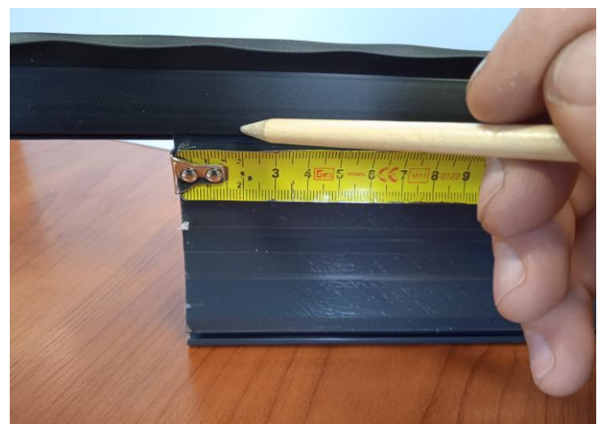
12. Z drugiej strony listwy dolnej odmierzamy 2 cm od końca listwy dolnej i zaznaczamy na listwie rezystancyjnej.
