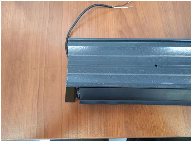
19. Wsuwamy przez wywiercony otwór drut tak aby przeciągnąć przewód.
