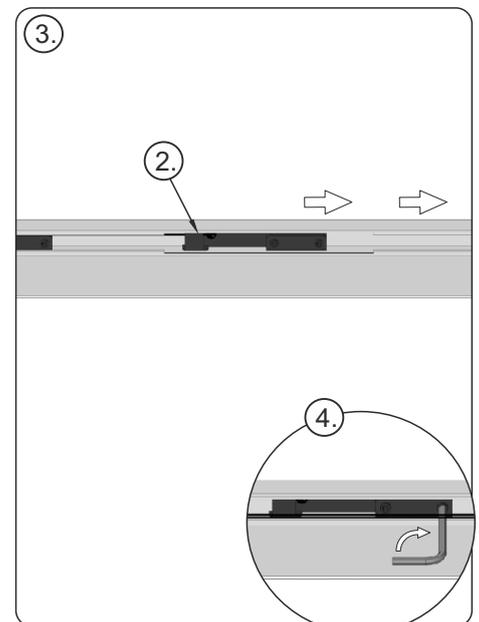
9. In dieselbe ausgefräste Öffnung (1) in der Oberschiene die zweite Sperre (2) einschieben, in die Richtung der gegenüberliegenden Seite als die erste (3) verschieben und dabei die Schnüre des Insektenschutzes anspannen. Die Sperre durch festziehen der Inbusschrauben (4) fixieren.
