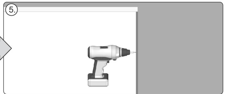
5. Das vormontierte Seitenprofil zuerst mit der Endkappe in die Endleiste (1) einsetzen, danach das Profil bis zur Seite der Nische einschieben – sein oberer Teil muss sich ebenfalls in dem oberen Profil (2) befinden. An der Wand die Stellen für die Öffnungen (3) markieren, das Seitenprofil ablegen. Danach Öffnungen für die Montagedübel (4) bohren. Das vormontierte Seitenprofil mit der Wand (5) verschrauben.
