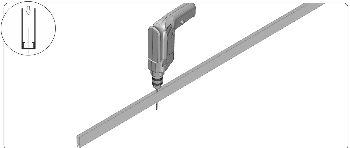
1. Mit einem 4,2 mm-Bohrer Montageöffnungen in der Oberschiene des Insektenschutzes anbohren. Die Öffnungen sollen je 50 cm gebohrt werden, nicht weniger als 3 im Profil.
