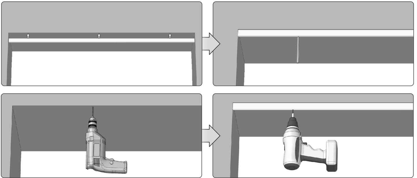
2. Die obere Leiste des Insektenschutzes in der oberen Nische der Türöffnung ausrichten, Öffnungen für Montagedübel markieren und bohren.
