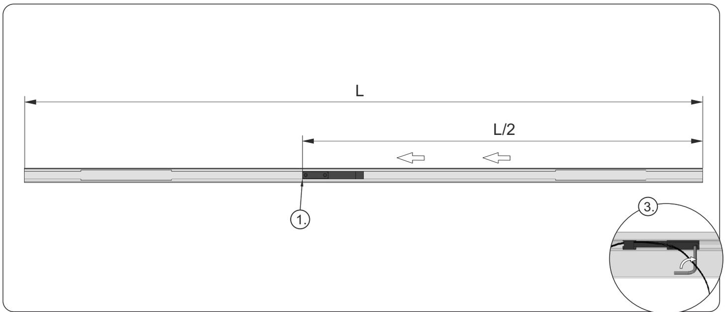
8. ...damit sich das Ende der Sperre (1) genau mittig der Oberschiene befindet. Die Sperre durch festziehen der Inbusschrauben (2) fixieren.
