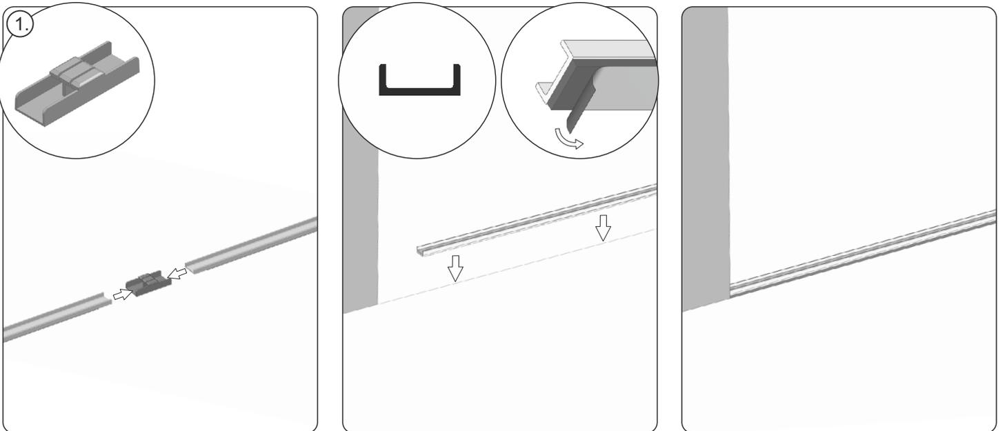
3. Die zwei Endleisten miteinander mit der Schnursperre (1) befestigen. Mit einem Band, das sich unterseitig an der Leiste befindet, die Endleisten mit dem Untergrund verkleben.
