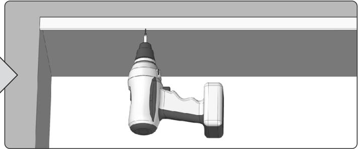
2. Die obere Leiste des Insektenschutzes in der oberen Nische der Türöffnung ausrichten, Öffnungen für Montagedübel markieren und bohren.
