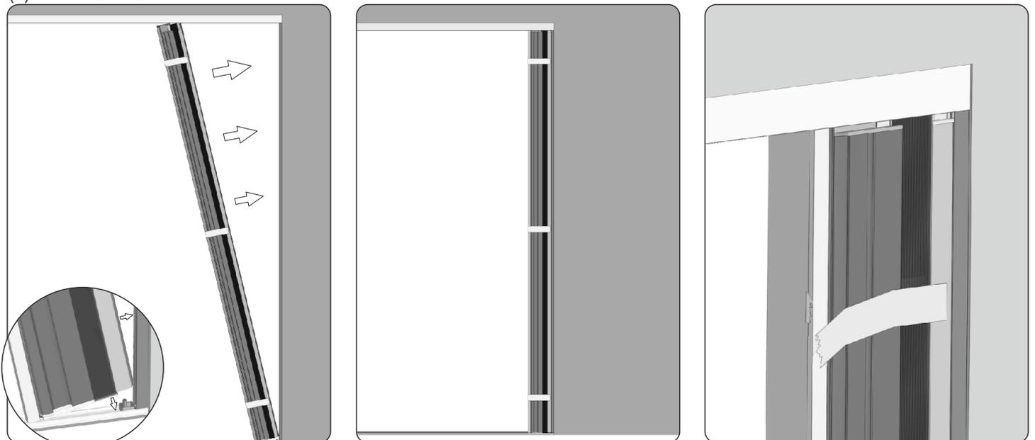
6. Das Insektenschutz-Paket montieren: zuerst den unteren Teil des Profils auf den herausragenden Bolzen in der unteren Endkappe des Seitenprofils aufschieben. Das Paket festhalten und das Befestigungsband des Insektenschutzes entfernen (Papierband).
