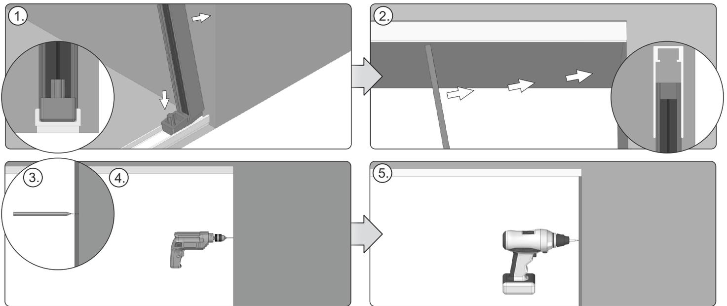
5. Das vormontierte Seitenprofil zuerst mit der Endkappe in die Endleiste (1) einsetzen, danach das Profil bis zur Seite der Nische einschieben – sein oberer Teil muss sich ebenfalls in dem oberen Profil (2) befinden. An der Wand die Stellen für die Öffnungen (3) markieren, das Seitenprofil ablegen. Danach Öffnungen für die Montagedübel (4) bohren. Das vormontierte Seitenprofil mit der Wand (5) verschrauben.
