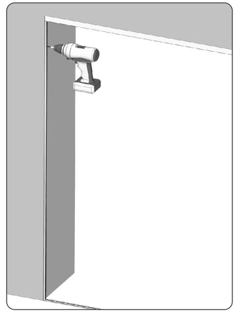
8. Den Magnet (1) lösen und aus dem Profil (2) herausziehen. Dann (ständig besonders auf die Schnüre des Insektenschutzes Acht geben, sodass sie nicht verwickelt oder verdreht sind!) entsprechende Stellen markieren und Öffnungen bohren. Das Profil mit der Wand verschrauben.
