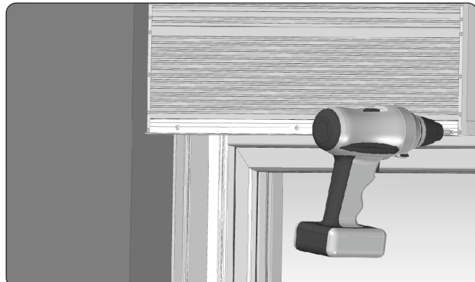
18. W celu ułatwienia montażu pakietu żaluzji fasadowej odkręcić czołową klapę rewizyjną.
